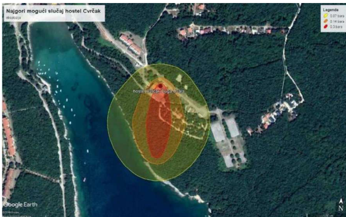
Slika 9. Prikaz zona ugroženosti u slučaju ispuštanja UNP-a iz spremnika i nastanka eksplozije
